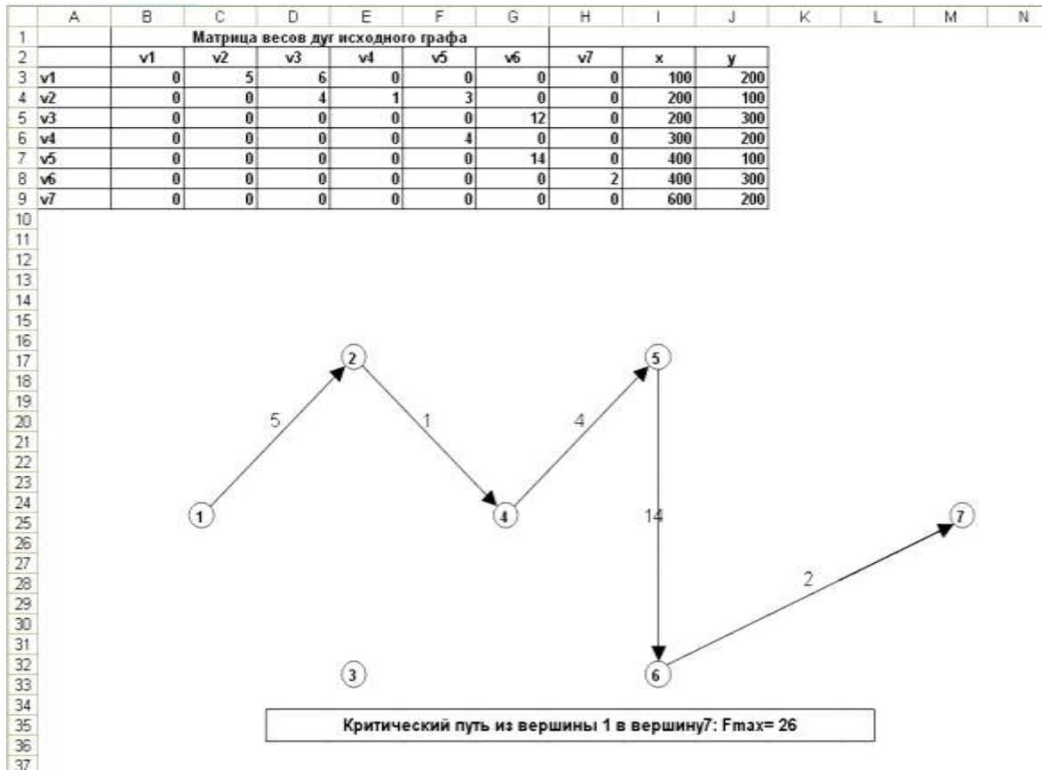
Рис. 51. Результат изображения критического пути в графе подпрограммой MaxPathPainter
